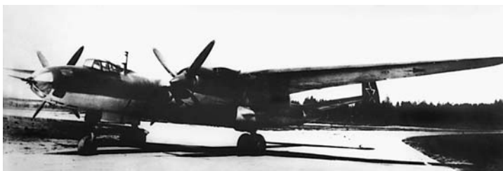
ДВБ-102 с двигателями М-71 на государственных испытаниях
