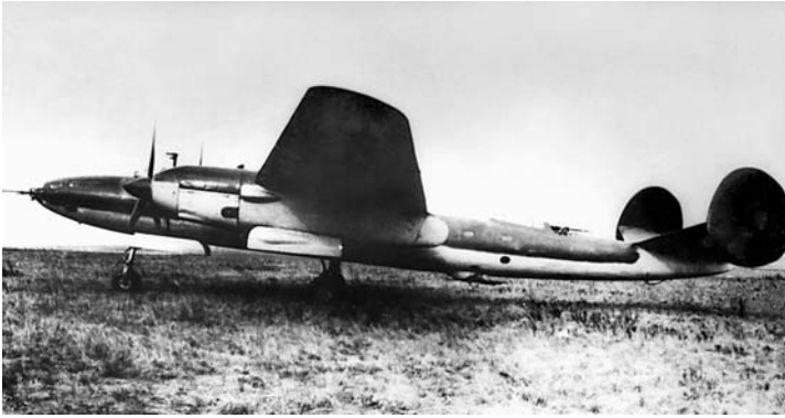
Первый вариант дальнего высотного бомбардировщика ДВБ-102 с моторами М-120
