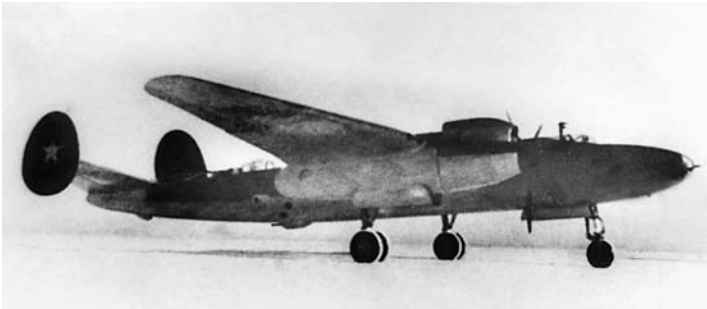
Самолет ДВБ-102 с моторами М-120, оснащенными турбокомпрессорами
