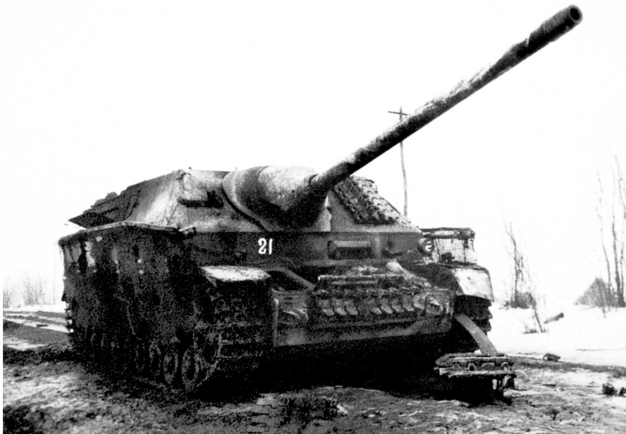
Истребитель танков Pz.IV/70 (А), подбитый в районе озера Балатон. Февраль 1945 года. Машина имеет сетчатые бортовые экраны и остатки зимнего камуфляжа. Номер 21 нанесен советской трофейной командой (АСКМ).
