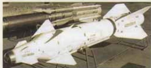
Управляемая ракета Х-29Л с лазерной ГСН
