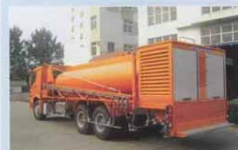
WGFS24Y для нанесения противообледенительного реагента на аэродромные покрытия
