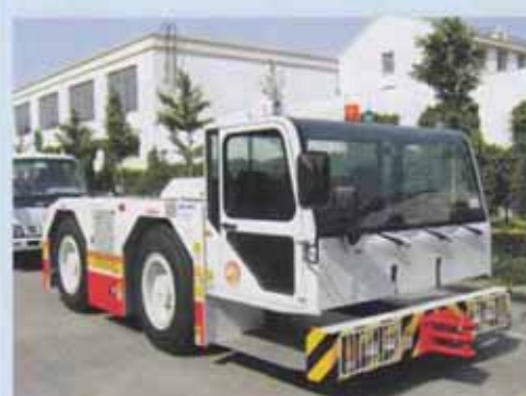
Аэродромный тягач для буксировки ВС с взлетной массой до 180 тонн
