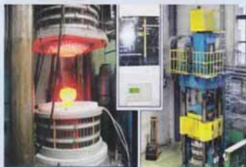
Участок изотермической штамповки. Специализированные прессы усилием 1600 и 630 тс. Программное управление процессами нагрева заготовок и штамповки
