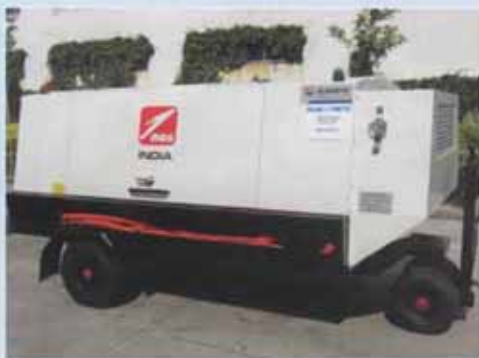
Наземный источник электропитания WGPT мощностью 140 кВА
