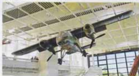
Дорнье Do-29. Отклоняемая винтомоторная группа - довольно интересное решение для обеспечения КВП
