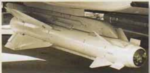
Управляемая ракета Х-29Т предназначалась для поражения сильно защищенных объектов
