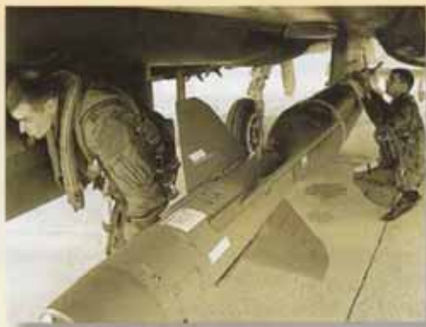
Управляемая авиабомба GBU-28 с проникающей боевой частью
