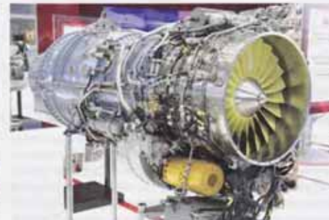
Двигатель АЛ-55И для индийского самолета НТТ-36. НПО «Сатурн» стало первым российским предприятием, получившим заказ на полномасштабную разработку авиационного двигателя для нужд иностранного государства
