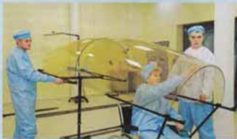
Откидная часть фонаря кабины летчика с нанопокрывтием
