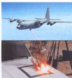
Инфракрасный тактический лазер ATL воздействует на капот автомобиля. В реальности, на верхнем рисунке, луч лазера невидим
