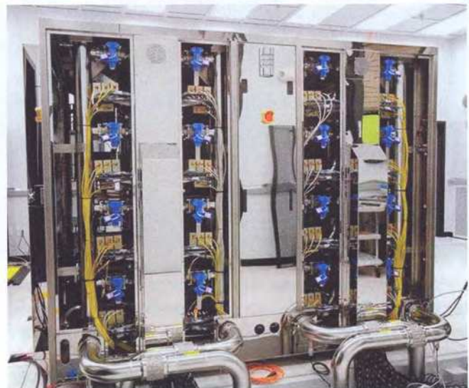
Лазерная установка-демонстратор — laser weapon system demonstrator, разработанная по программе JHPSSL (3-я фаза разработок). На нижнем снимке панели сняты
