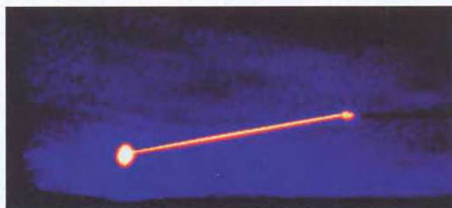
Инфракрасное изображение лазерного излучателя самолёта Boeing 747-400F (справа), теплового следа луча в атмосфере и нагретой области типичной баллистической ракеты малой дальности. 11 февраля 2010 г.
