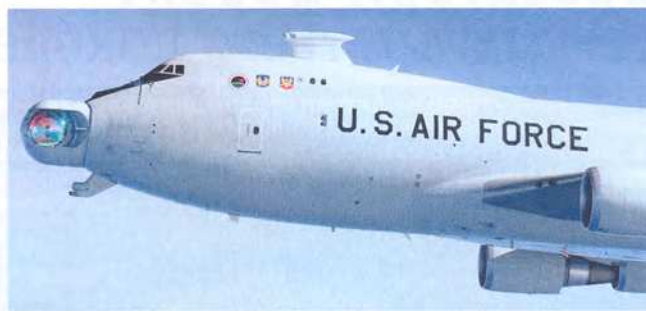
Модифицированный самолёт Boeing 747-400F с лазерным излучателем в носовой части
