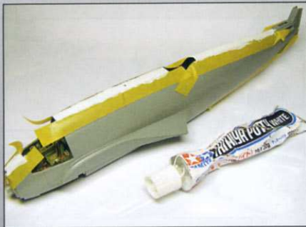
Половины фюзеляжа склеены и нанесена шпаклевка. Склеены детали крыла. Зазоры устранены тонким полистиролом. С помощью пилки и скрайбера удалены заменяемые части модели.
