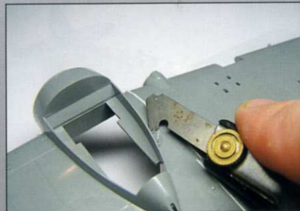
После удаления мотогондол консоли потеряли жесткость, которая была восстановлена вставками из тонкого полистирола.
