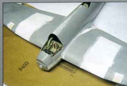
Вставки в крыло из набора SMK имеют профиль, отличный от профиля крыла, поэтому обшивку сделал из листового полистирола, зашпаклевал щели и зачистил наждачной бумагой. Смоляные детали отделял от литников с помощью микропилки Olfa. Обтекатели и вставки из набора SMK потребовали не только подгонки, но заделки щелей двухкомпонентной шпаклевкой Tamiya.
