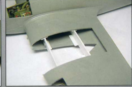
После удаления мотогондол консоли потеряли жесткость, которая была восстановлена вставками из тонкого полистирола.
