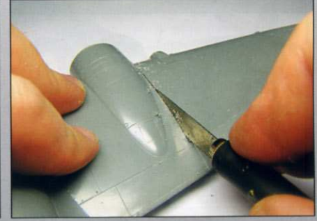
Половины фюзеляжа склеены и нанесена шпаклевка. Склеены детали крыла. Зазоры устранены тонким полистиролом. С помощью пилки и скрайбера удалены заменяемые части модели.
