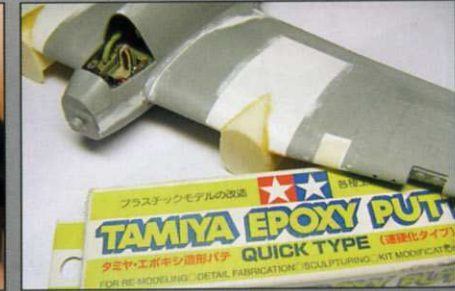
Вставки в крыло из набора SMK имеют профиль, отличный от профиля крыла, поэтому обшивку сделал из листового полистирола, зашпаклевал щели и зачистил наждачной бумагой. Смоляные детали отделял от литников с помощью микропилки Olfa. Обтекатели и вставки из набора SMK потребовали не только подгонки, но заделки щелей двухкомпонентной шпаклевкой Tamiya.
