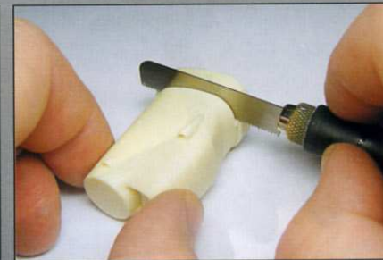
Вставки в крыло из набора SMK имеют профиль, отличный от профиля крыла, поэтому обшивку сделал из листового полистирола, зашпаклевал щели и зачистил наждачной бумагой. Смоляные детали отделял от литников с помощью микропилки Olfa. Обтекатели и вставки из набора SMK потребовали не только подгонки, но заделки щелей двухкомпонентной шпаклевкой Tamiya.
