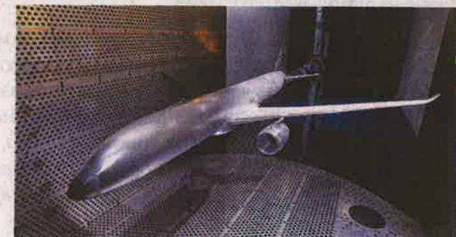
В ЦАГИ прошли исследования модели нового российско-китайского широкофюзеляжного дальнемагистрального самолёта (ШФДМС) CR929
